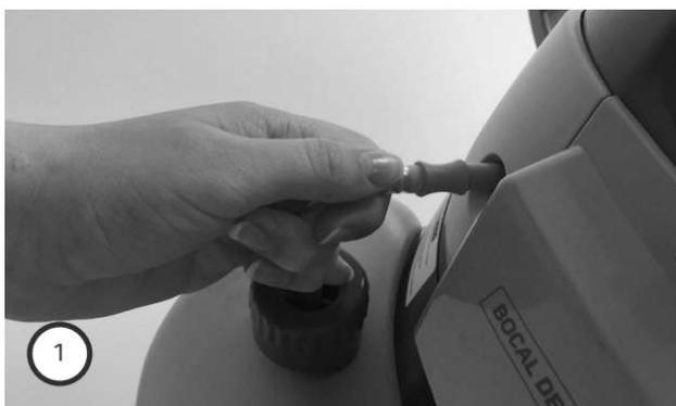
1. Desconecte a mangueira de sucção de água limpa/ solução.
