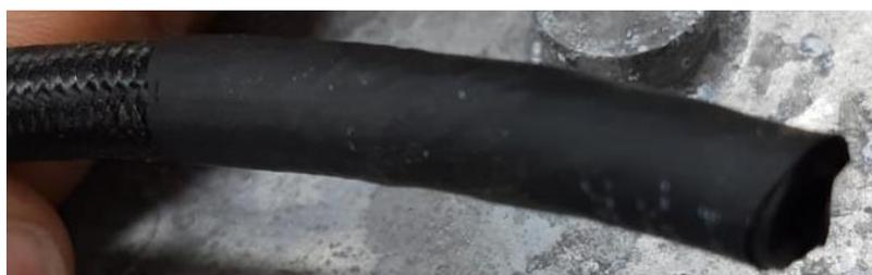
Com o termo retrátil na posição correta (indicado no passo anterior), será necessário um soprador térmico para cumprir este passo, que consiste em apontar o soprador térmico na direção do termo retrátil até que ele encolha e fique justo fixando a mangueira e a parte desfiada do tecido isolante, como mostra a imagem acima.
