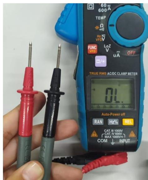
Quando as pontas de prova entram em contato uma na outra a leitura indica o valor zero, ou seja, significa que o circuito está fechado. Nesta situação o multímetro emite um sinal sonoro de alerta, toda vez que o sinal de alerta estiver sendo emitido significa que o circuito ou cabo possui continuidade, não está rompido.
